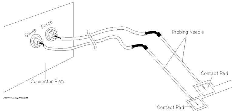
この例ではテストリードを使用していますが、リーク電流を低減するには、同軸ケーブルを使用してください。
