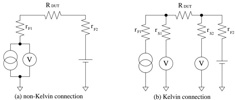
ケルビン接続は電圧を印加する時にも有効です。フォース線の残留抵抗による電圧降下は、センス回路によって電圧源にフィードバックされます。センス回路のインピーダンスは非常に大きいので、センス線を通る電流は少なく、センス線の残留抵抗 ( $10 \Omega$  以下) による電圧降下は無視できます。従って、フォース線とセンス線の接点では、フォース線の電圧降下を補正した電圧出力がなされます。
