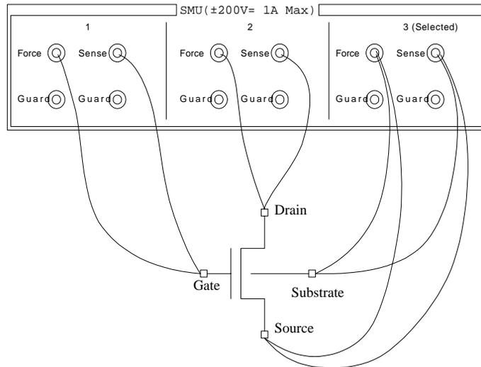
残留抵抗の影響を極力少なくするために、2本のテストリードの接続は、できる限り DUT の端子に近い場所で行ってください。
